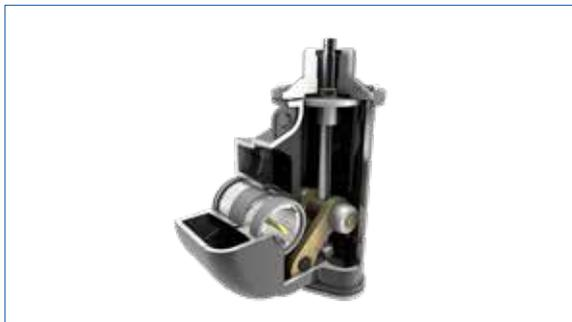
El reductor con mecanismo de biela y manivela SKG se diseña y fabrica en ERHARD, en Heidenheim. Se adapta a la curva de par de la válvula y tiene pares de torsión constantemente bajos. Su comportamiento de cierre en dos pasos protege contra los daños por golpes de ariete.
