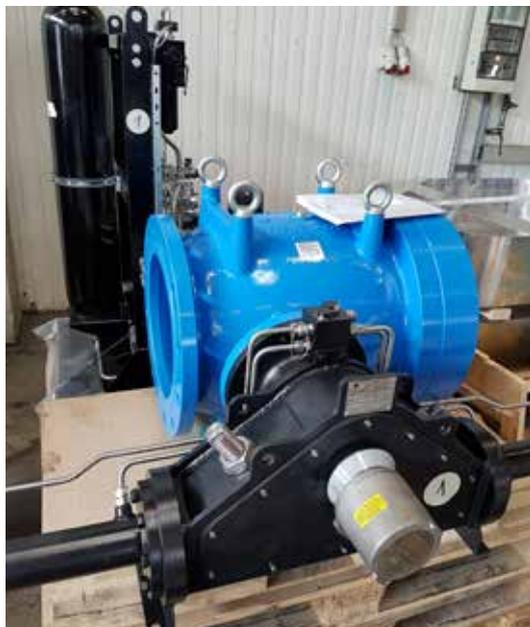
Como alternativa al diseño de resorte, a efectos de una función de seguridad, un actuador de doble efecto puede estar equipado con un acumulador de energía, como una vejiga o un peso.
